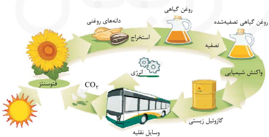
فرایند چرخه‌ای تولید گازوئیل زیستی از دانه‌های روغنی
