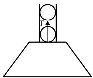
۱۷۹- مطابق شکل زیر دو گلوله کوچک مشابه با بارهای  $q = 5 \mu\text{C}$  به فاصله  $30 \text{ cm}$  از یکدیگر در یک لوله شیشه‌ای قائم با بدنه نارسانا و جرم  $5 \times 10^{-2} \text{ kg}$  در حال تعادل قرار دارند. چنانچه این مجموعه بر روی یک ترازو قرار گیرند، نیروی F چند نیوتون باشد، تا عدد نشان داده شده توسط ترازو صفر شود؟ ( $g = 10 \frac{\text{N}}{\text{kg}}$  و از اصطکاک صرف نظر شود.)
