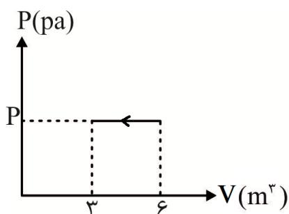
۱۷۲- نمودار شکل داده شده فرایند ترمودینامیکی یک گاز کامل تک اتمی را نشان می‌دهد. چنانچه طی این فرایند  $1500\text{ J}$  گرما از گاز گرفته شود. و انرژی درونی گاز در ابتدای فرایند  $3600\text{ J}$  بوده باشد، انرژی درونی گاز چند درصد و چگونه تغییر می‌کند؟
