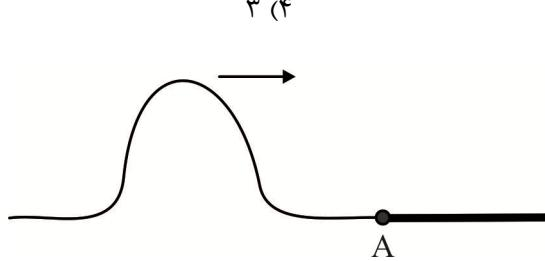
۱۹۴- در شکل زیر، دو طناب هم جنس و همگن یکی نازک و دیگری ضخیم در نقطه A به هم متصل شده‌اند. اگر قطر مقطع طناب ضخیم ۲ برابر طناب نازک باشد، وقتی یک موج سینوسی با طول موج λ از طناب نازک به سمت طناب ضخیم حرکت کند، طول موج عبوری و همچنین طول موج باز تابیده شده از نقطه A به ترتیب از راست به چه چند λ می‌شوند؟
